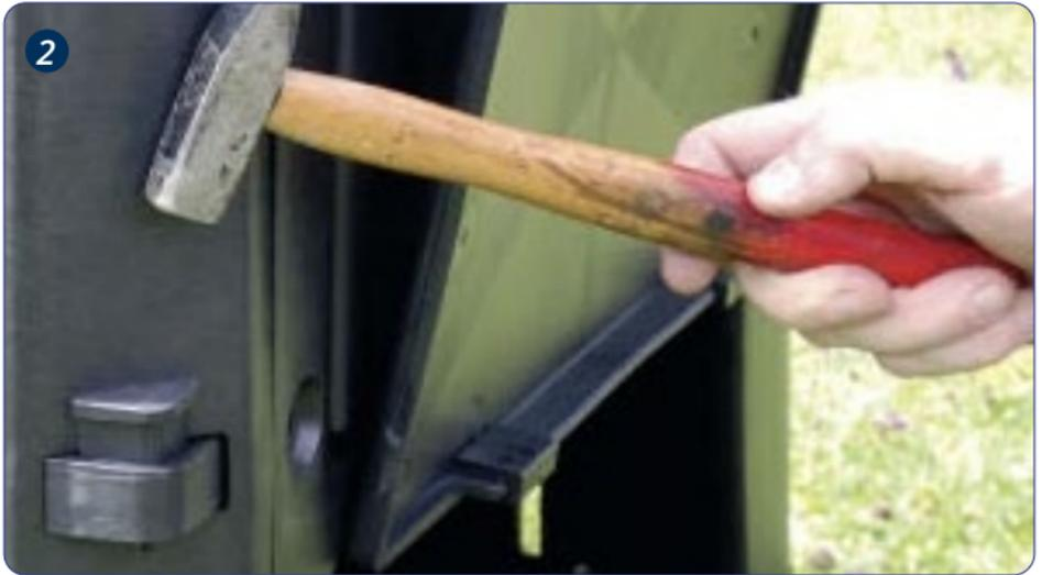
Verbindungskeile in die Rasthaken eindrücken (eventuell mit Zuhilfenahme eines Hammers)
