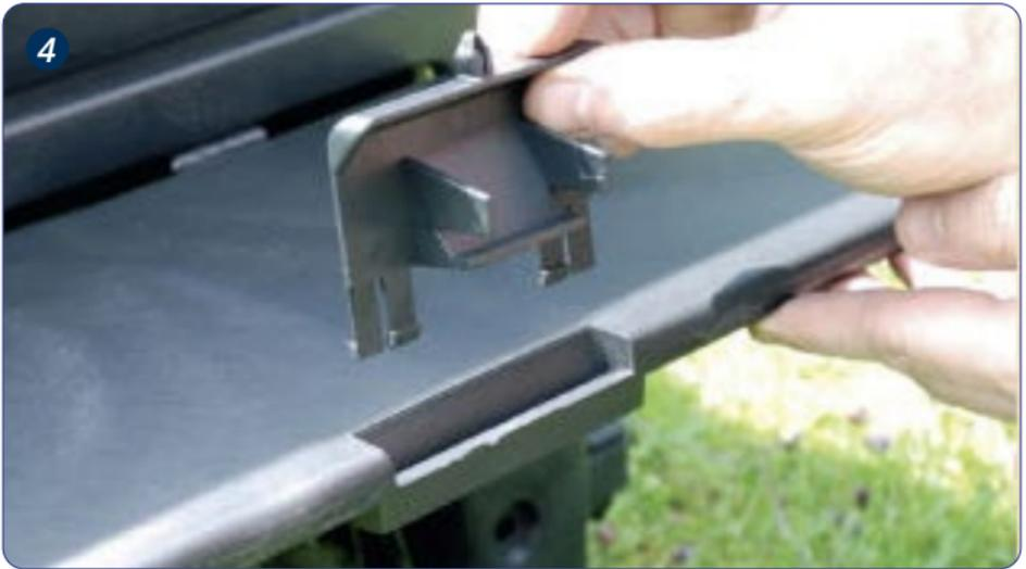
Scharnier auf den Steg der Öffnungsklappe stecken
